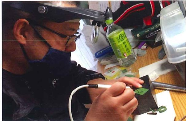
製作には、定規、リングゲージ棒、ヤスリなど用具もさまざま。全て伏見さんの私物です。主には、ワックスペンを使用します。電源でペン先が発熱し、ロウを削ったり、付け足したりと加工していきます。
